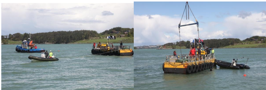
Lekteren med flyet under slep til venstre og overføring av løftet fra vinsjen på lekteren til kranen.
