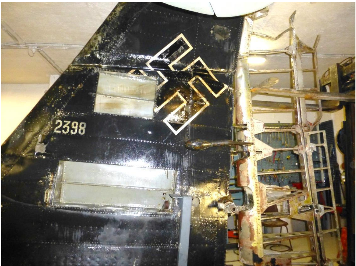
Bilde 5. Knekk på halefinnen og manglende luker / plater
