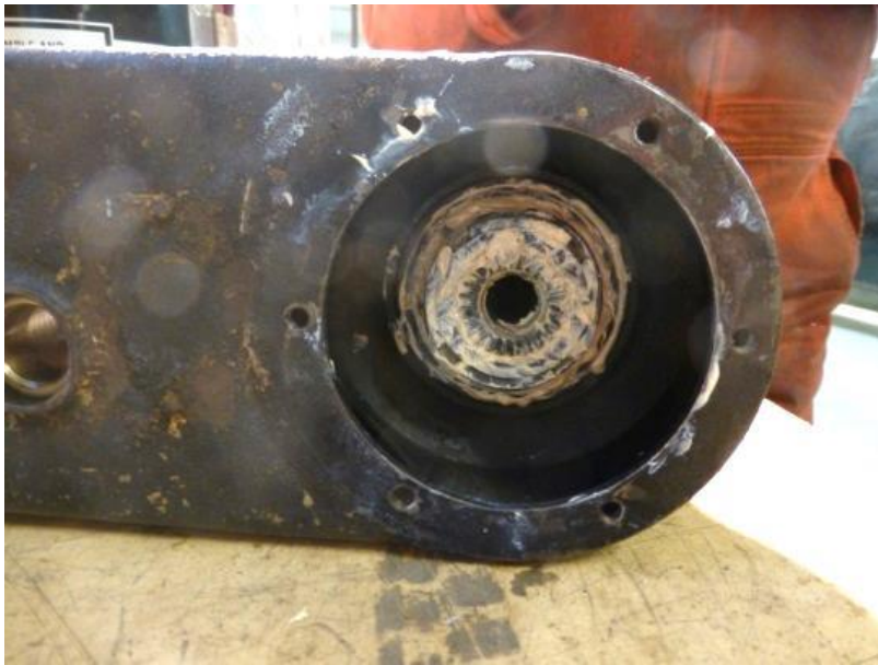
Bilde 26. De innvendige delene ble satt inn med smørefett før montering
