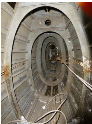
Bilde 2. Inne i bakkroppen før rensing og konservering
