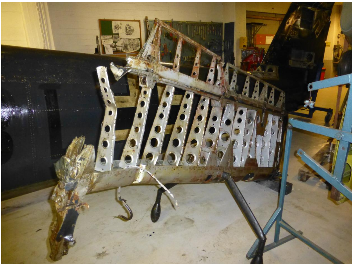
Bilde 7. Relativt stor skade på siderorets topp
