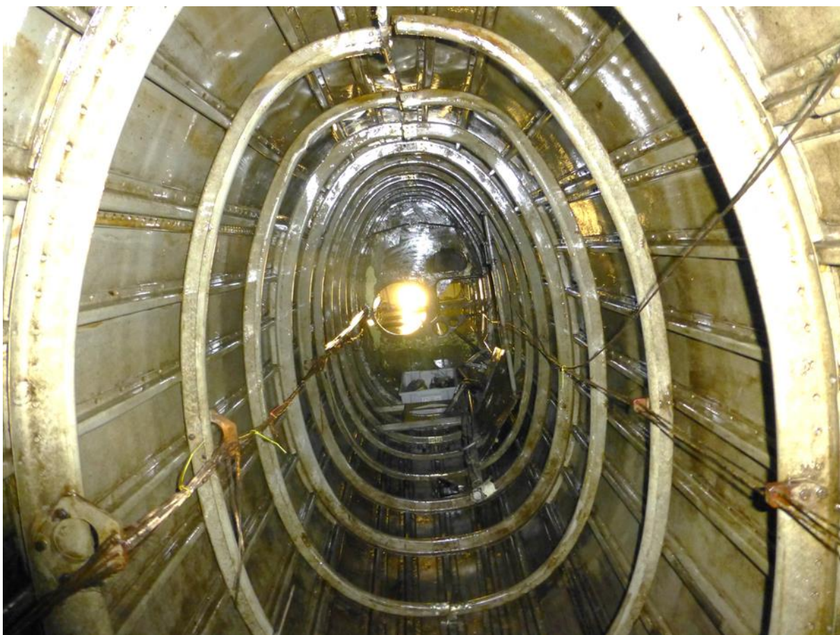
Bilde 21. Bakkroppen innvendig etter konservering.
