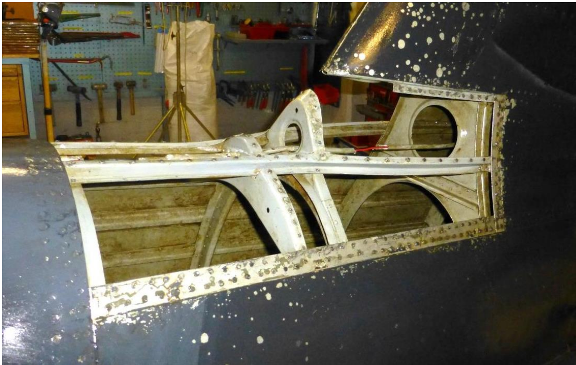
Bilde 6. Manglende plate ved roten av halefinnen
