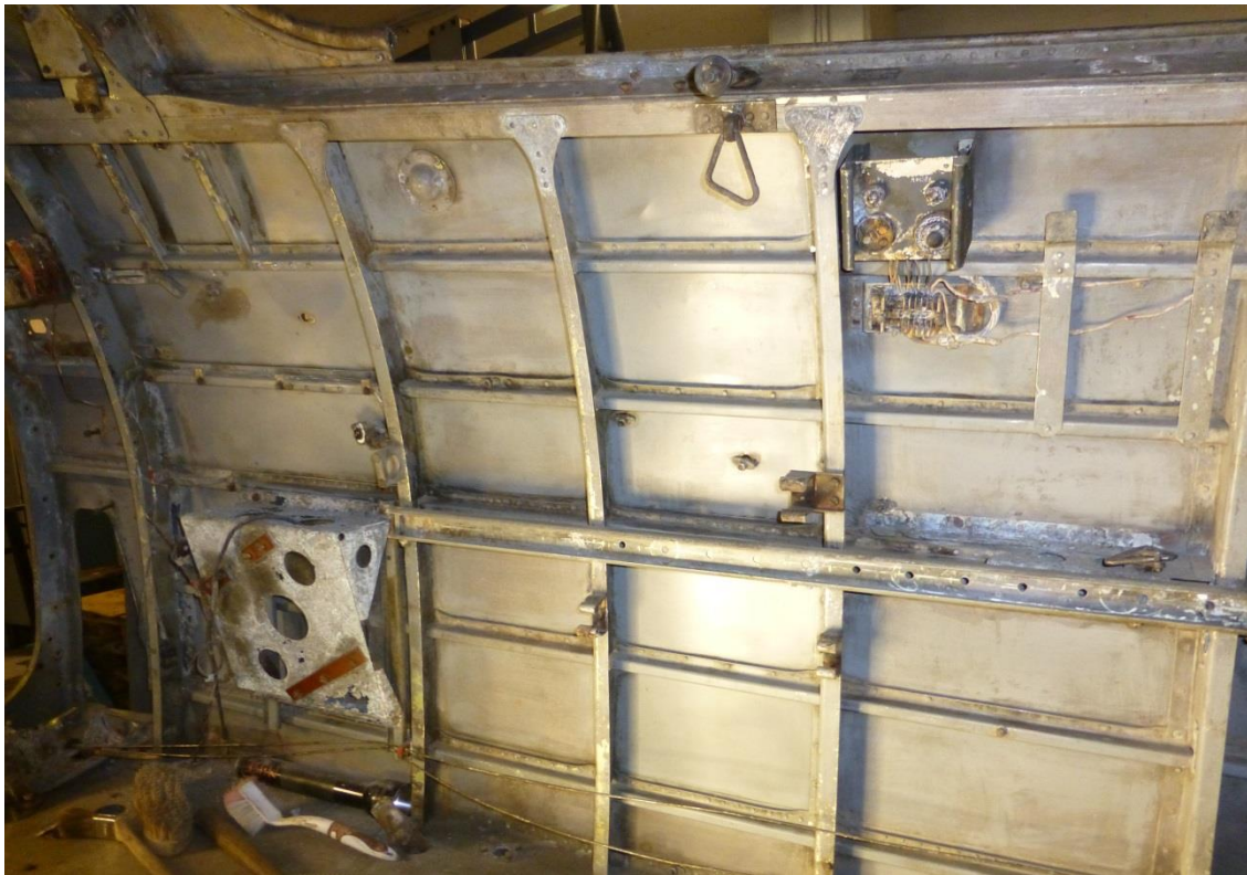
Bilde 18. Parti fra bakre cockpit etter at det er rensset videre med «Scotchbrite» og vasket med whitespirit
