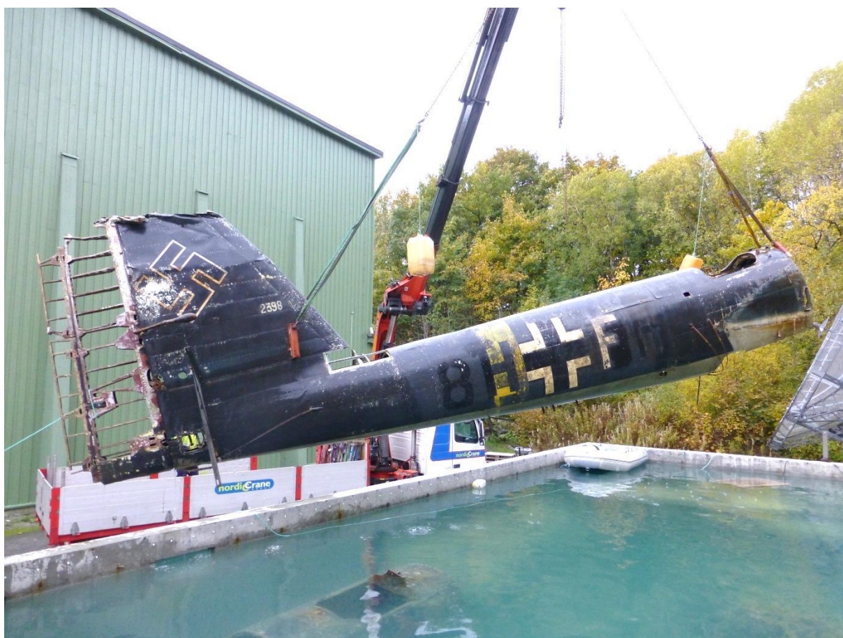
Bilde 13. Haleseksjonen heises ut av vanntanken for å konserveres oktober 2013
