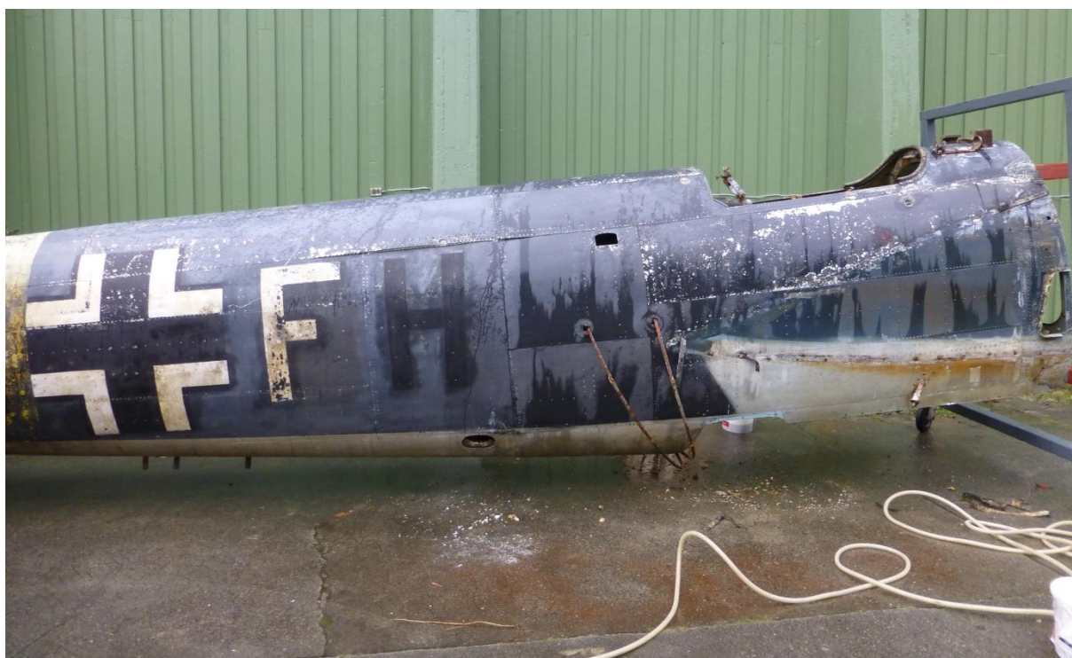
Bilde 16. Haleseksjonen etter utvendig rengjøring. Man ser at den sorte lakken er matt og grå. Det er vanskelig å se forskjell på helt sort og den mørke grå kamuflasjemalingen på dette stadiet
