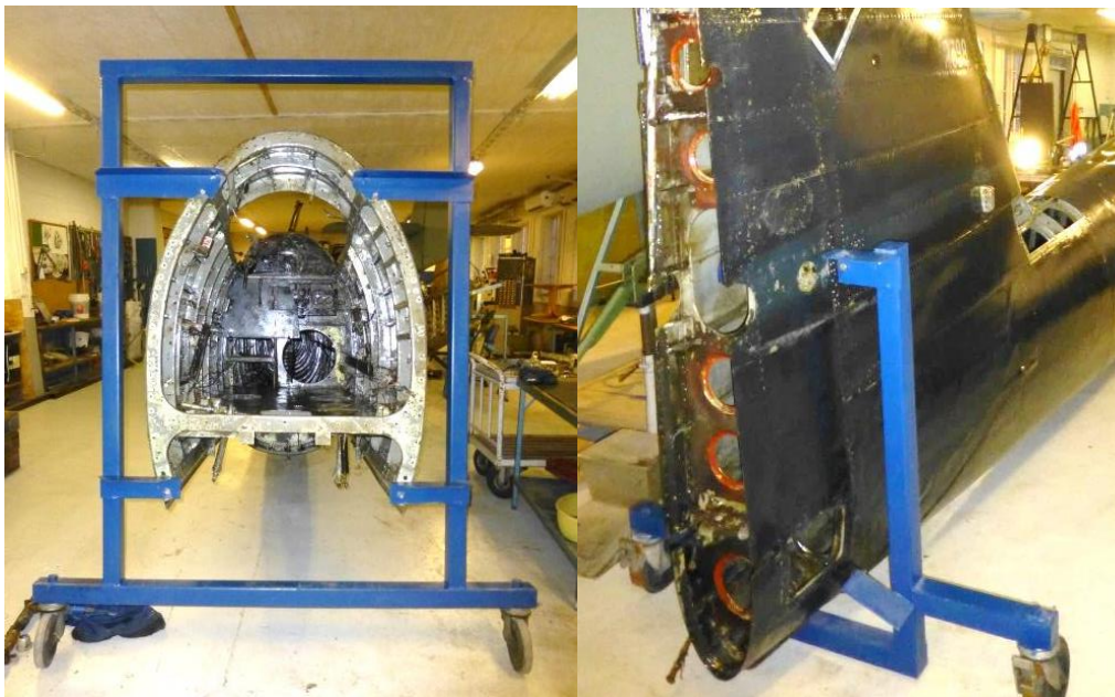
Bilde 14. Haleseksjonen ble montert på 2 rammer med hjul
