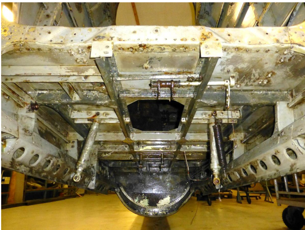
Bilde 20. Det ferdig konserverte bomberommet i haleseksjonen
