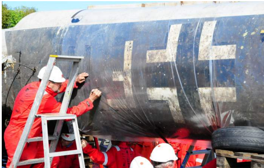
Over . Fra demontering av vingene. Vingene er er festet med fire store bolter, se under som var i forbausende god stand etter 70 under vann,
