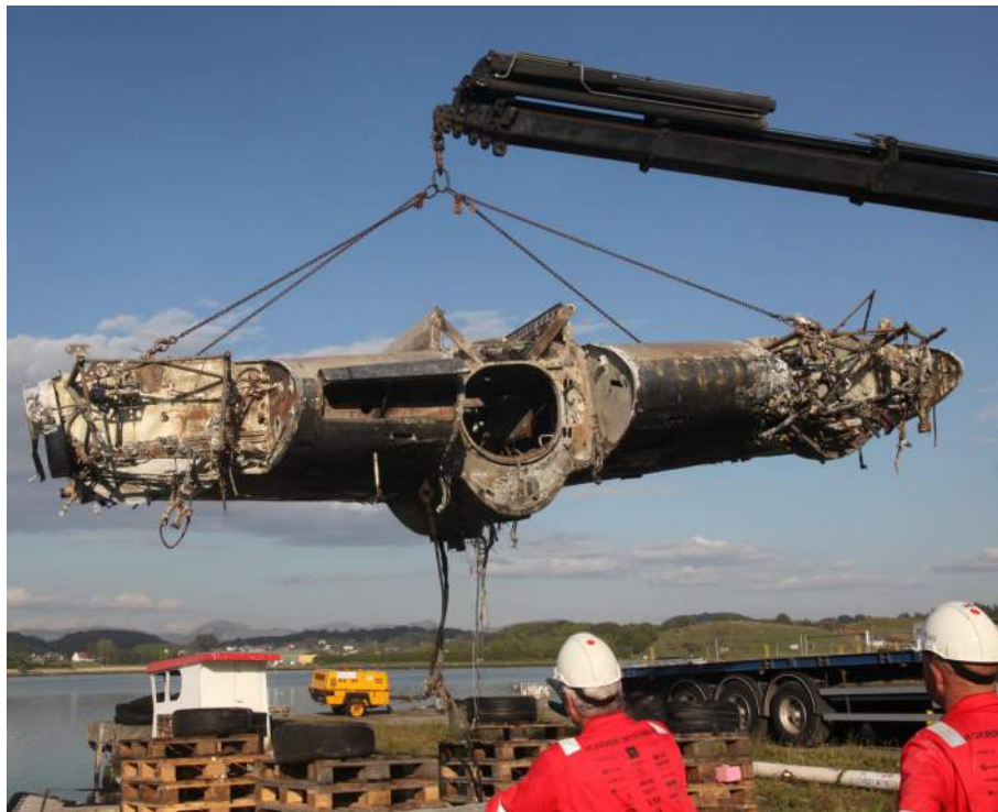
Over . Bakkroppen etter å ha blitt demontert. Under. Senterseksjonen var den siste delen som ble plasert i betongkaret
