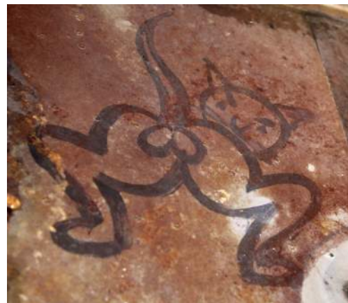
Til venstre. All merking på flyet ble tegnet over på plastfolie slik at merkingen kan rekonstrueres etter gjenoppbygging.
