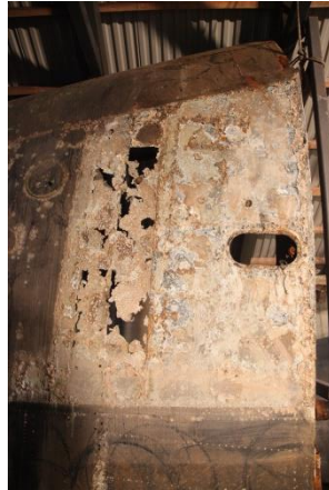
Korrosjonsskader på oversiden av vingen hvor platen må skiftes ut.
