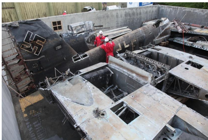
Flyet etter det var tatt på land, delt i seksjoner og plassert i karet før fylling med vann.
